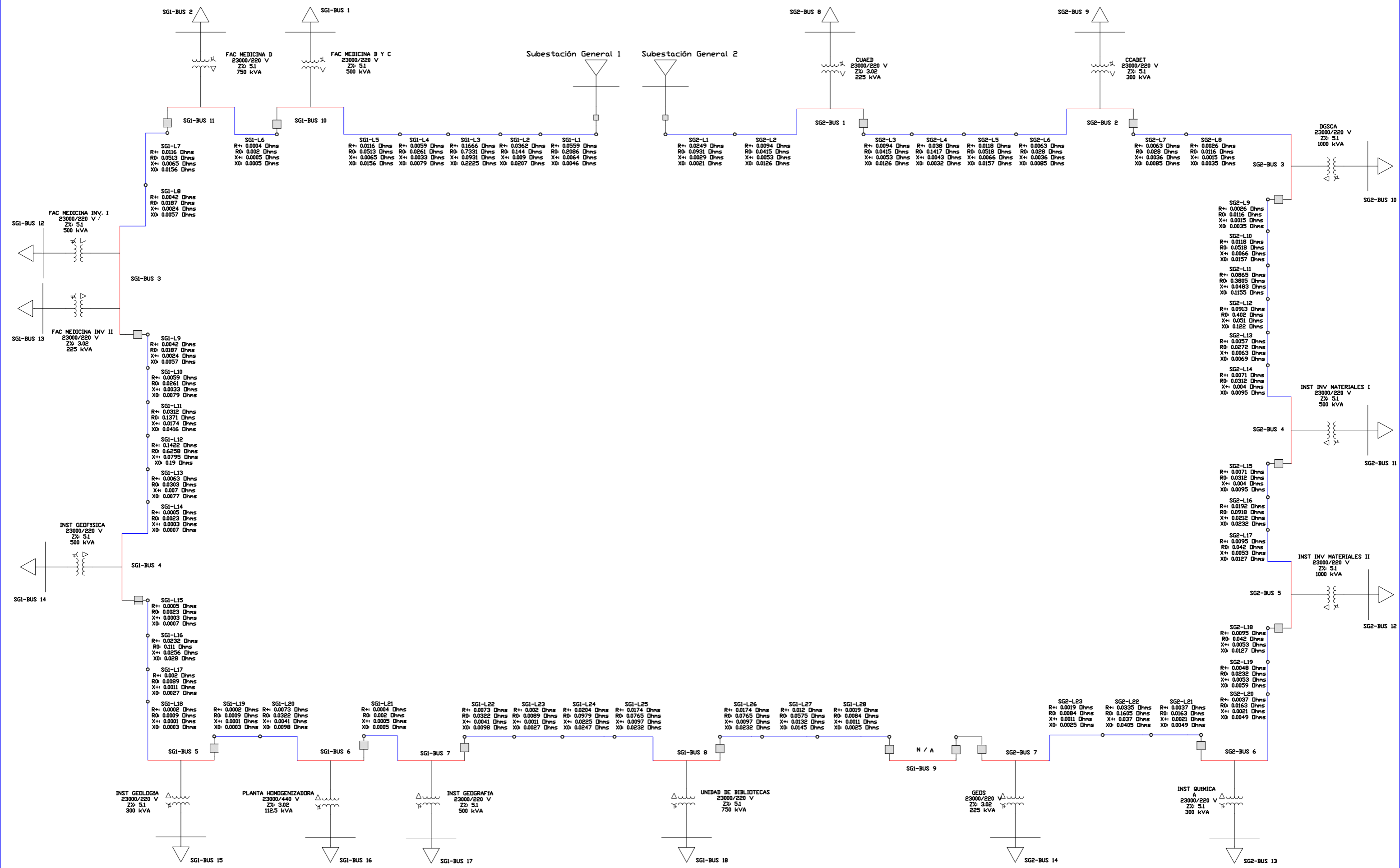
Figura No. 6.6. Diagrama unifilar del Anillo F.
