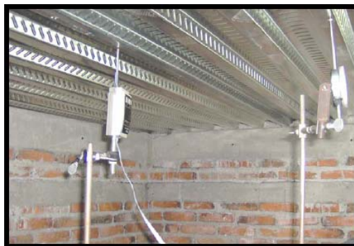
Figura 4.16 Medidores de desplazamiento (micrómetros) ubicados en sitios donde se desea conocer la deflexión producida por la carga
