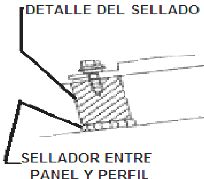
Figura 3.4.2. Sellado y fijación de la cubierta
