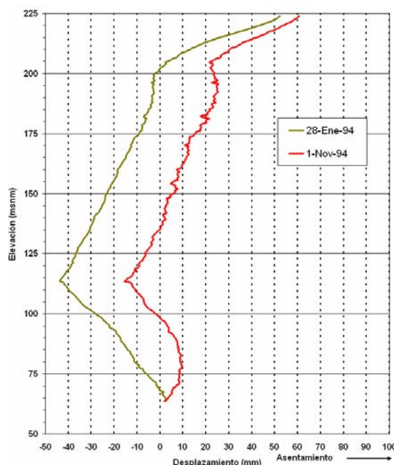
Fig. I. 118. Desplazamientos normales a la losa de concreto. Sección L-22. Inclínómetros inclinados.
