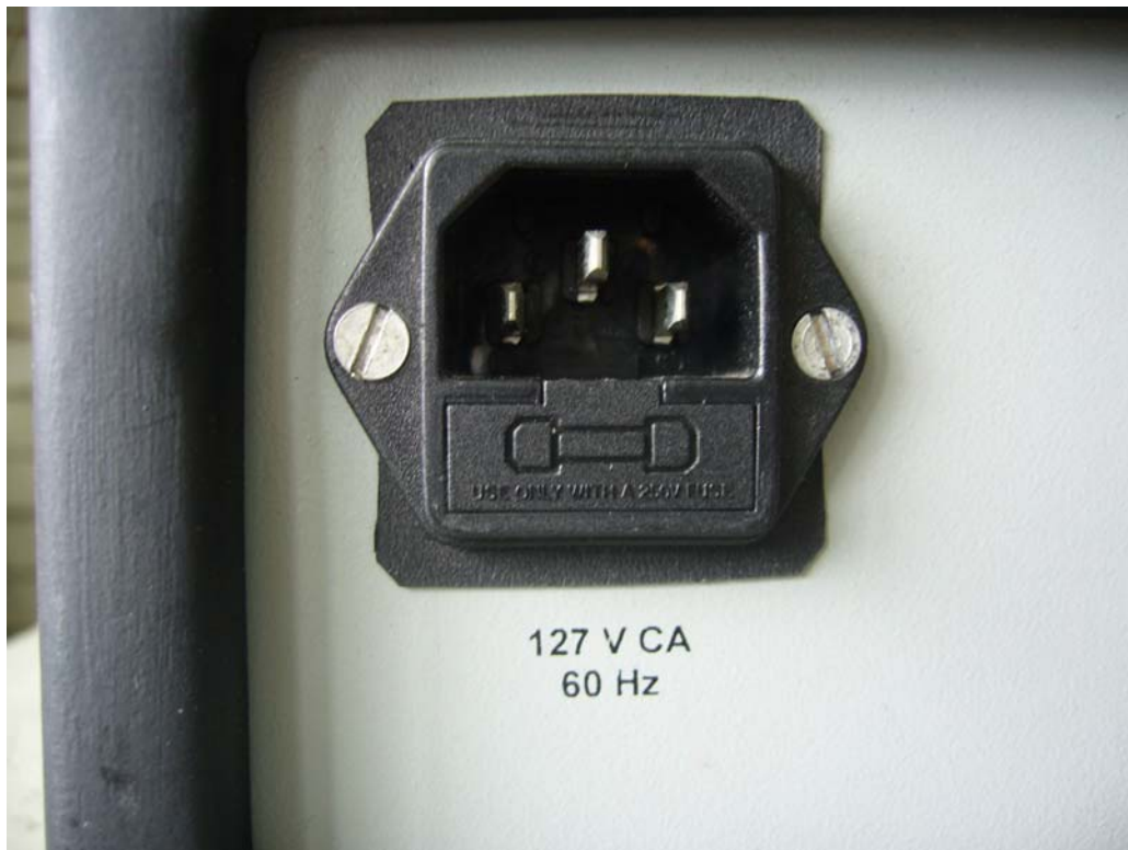
Figura 27. Detalle posterior, marcado de alimentación
