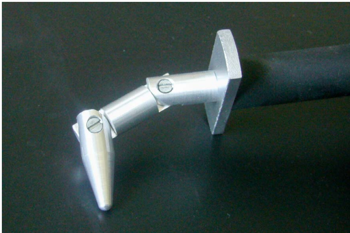
Figura A4. Fotografía del dedo de prueba articulado
