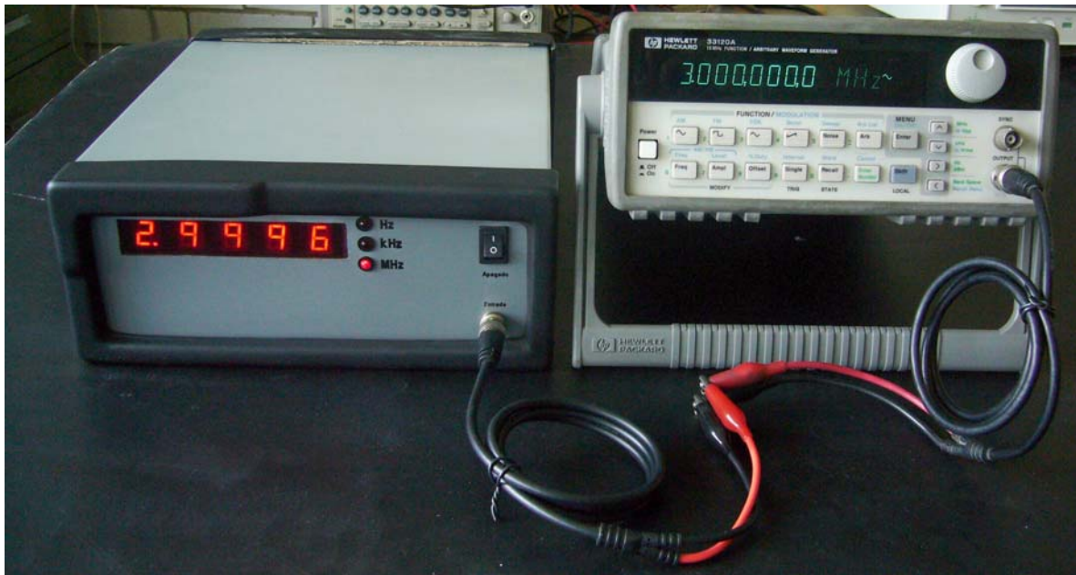
Figura 23. Fotografía de la conexión para obtención del error del frecuencímetro
