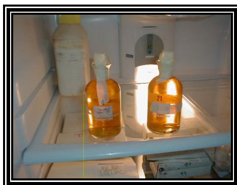
Figura 2.40 fijación del oxígeno disuelto en las muestras
