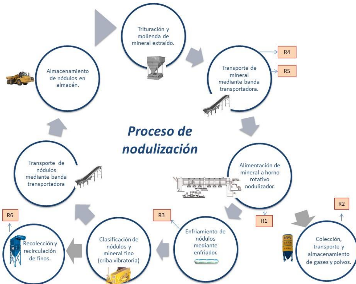
Figura 11. Esquema del proceso de nodulización.
