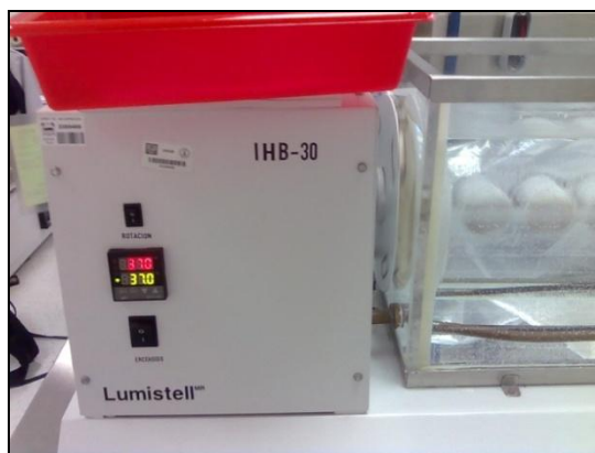
Figura 19 Dispositivo para la prueba de bioaccesibilidad, vista del motor
