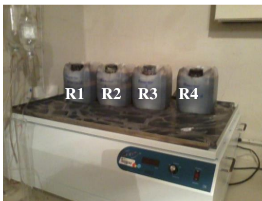
Figura 4.6 Reactores anaerobios utilizados en la etapa de aclimatación de biomasa a la tilosina
