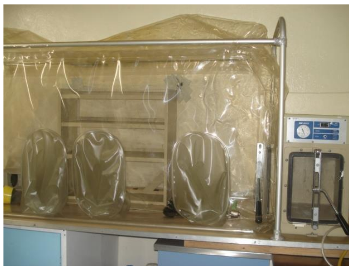
Figura 4.4 Cámara de ambiente anaerobio utilizada en la experimentación
