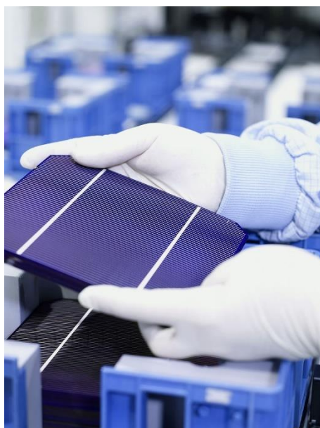
Figura 2. Celda de silicio de un módulo solar
