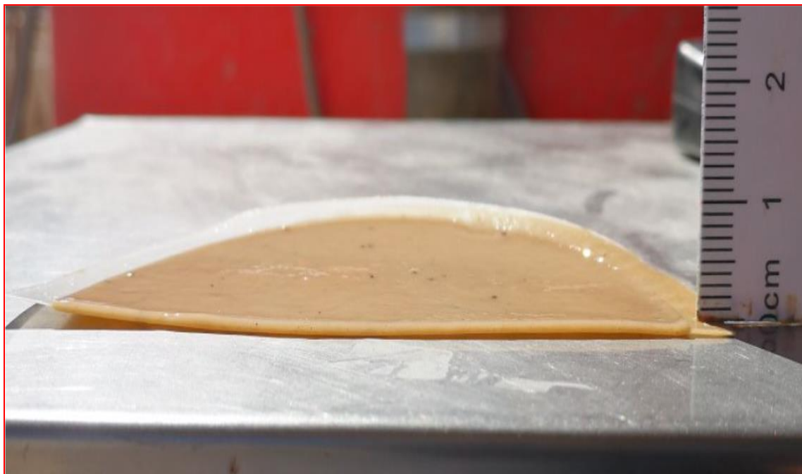
Figura 20. Resultado prueba de Cake en lodo bentonítico antes de colar muro Pantalla. (CIMESA, 2016).
