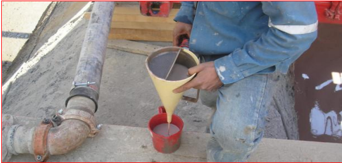
Figura 77. Realización de la prueba de viscosidad; Autor: Ing. Francisco Israel Callejas Quezada. (CIMESA 2011).
