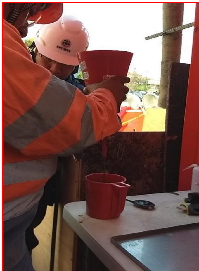
Figura 78. Realización de la prueba de viscosidad; proyecto "MARNHOS, Lago Filt 7". (CIMESA 2018).
