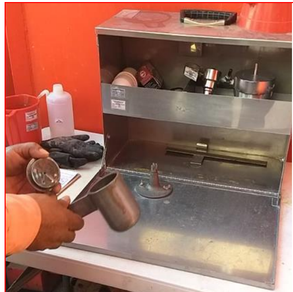
Figura 79 y 80. Realización y verificación de la prueba de densidad; proyecto "MARNHOS, Lago Filt 7". (CIMESA 2018).
