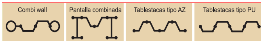
Figura 22. Configuración tablestacas. (CIMESA, 2012).
