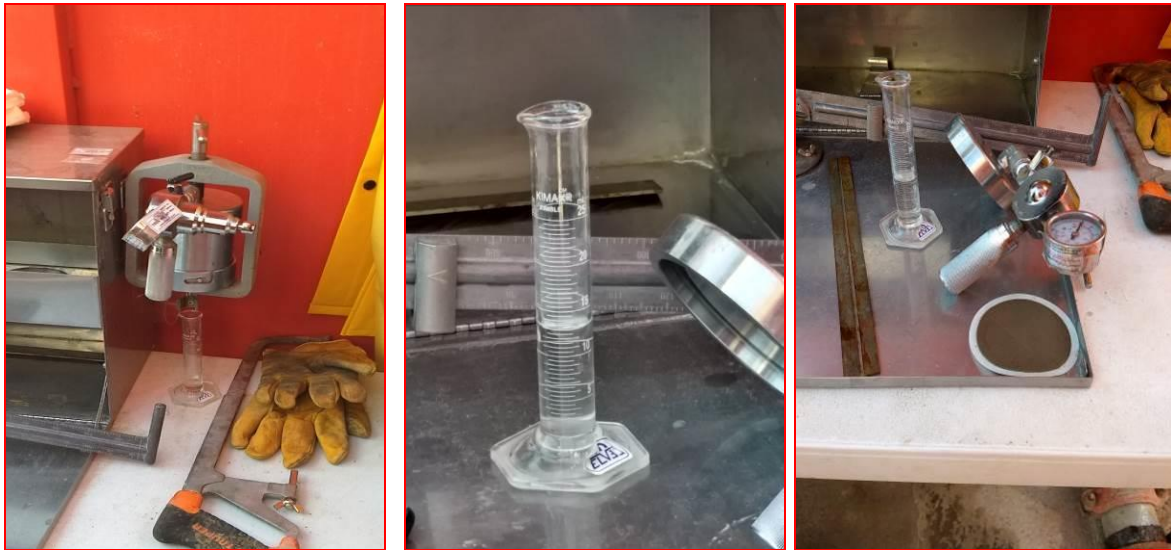
Figura 85, 86 y 87. Realización de la prueba de cake y de filtrado; proyecto "MARNHOS, Lago Filt 7". (CIMESA 2018).
