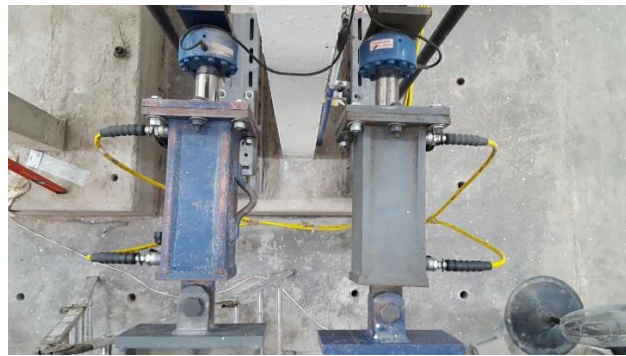
Figura 3.9. Arreglo de piezas de acero utilizadas para aplicar carga lateral. a) Diagrama, b) vista frontal, c) vista en planta
