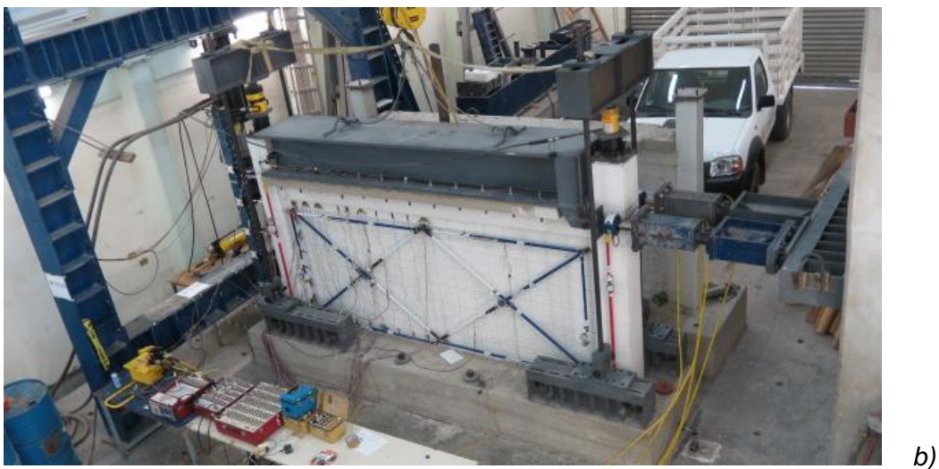
Figura 3.7. Marco de carga completo. a) Diagrama, b) fotografía
