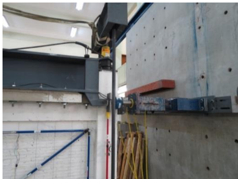
Figura 3.9. Arreglo de piezas de acero utilizadas para aplicar carga lateral. a) Diagrama, b) vista frontal, c) vista en planta
