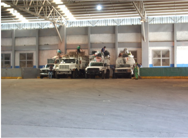
Figura 6.5 Tolva con 4 camiones descargando en forma simultanea
