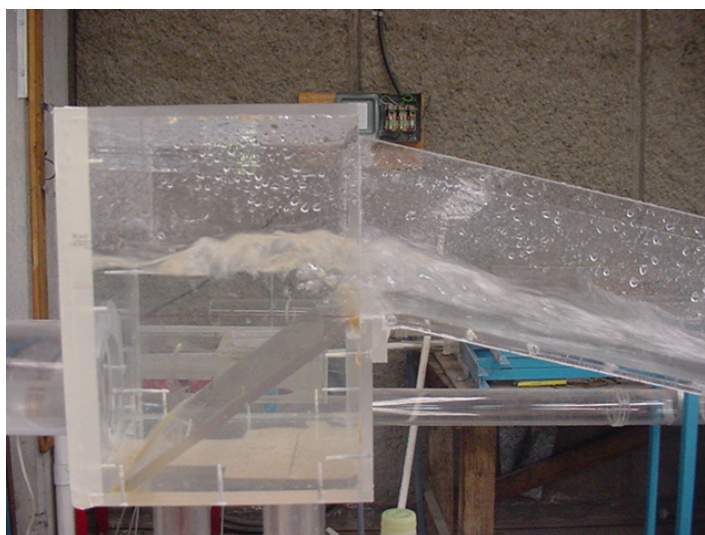
Imagen 4. 4 Funcionamiento del segundo registro con pared inclinada
