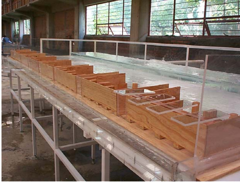
Imagen 3.1 Descarga de los DEV al canal colector
