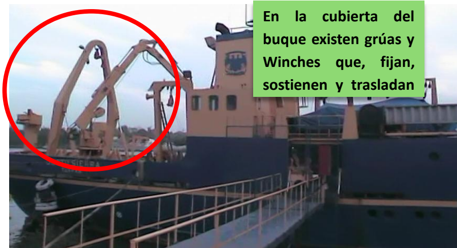
Fotografía 3.2 Popa del B/O “Justo Sierra” en la que se muestra su sistema de grúas
