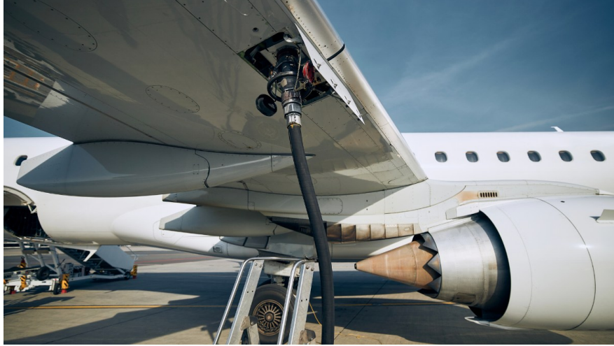
Figura 1.8: Reabastecimiento de combustible de una aeronave. Fuente: Tomado de ARC Refuellers (2025)
