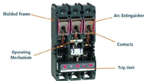
Figura 2.3 Componentes de un MCCB 3
