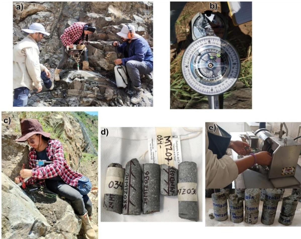
Figura 21. Método de perforación, a) Perforación de núcleos, b) Orientación de núcleo con brújula magnética y solar, c) marcado del núcleo antes de sacarlo, d) codificación de núcleos, y e) corte y marca de especímenes.
