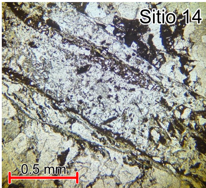
Figura 42. Lámina delgada del sitio 14 en donde se aprecia las vetillas de opacos, con luz paralela.
