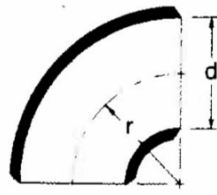
Figura 69. Factor de pérdidas para uniones de 90° (Crane, 1980).
