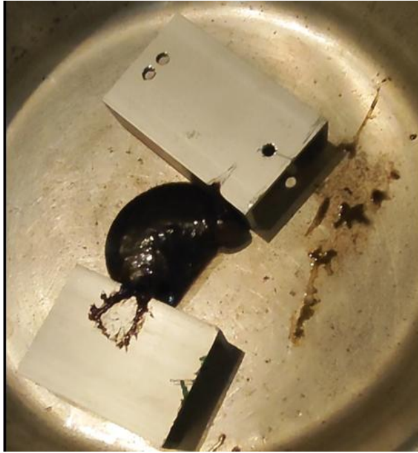
Ilustración 32. Aislante a 160 °C.
