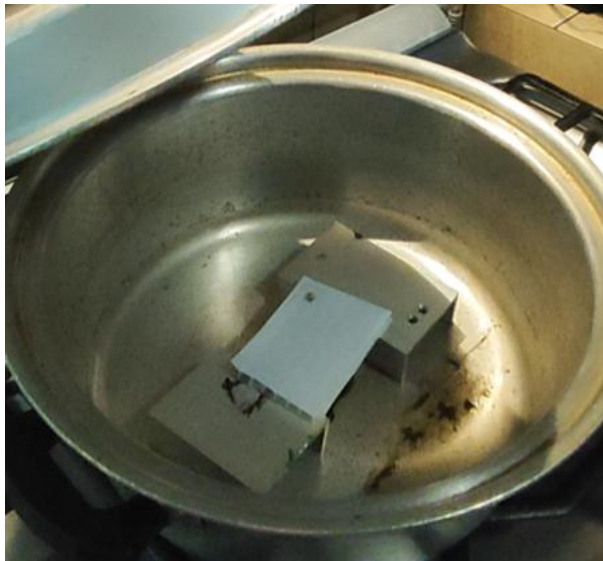
Ilustración 35. Policarbonato a 160 °C.
