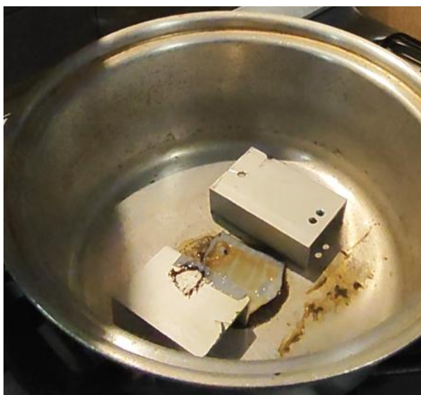
Ilustración 37. Policarbonato a 235 °C.
