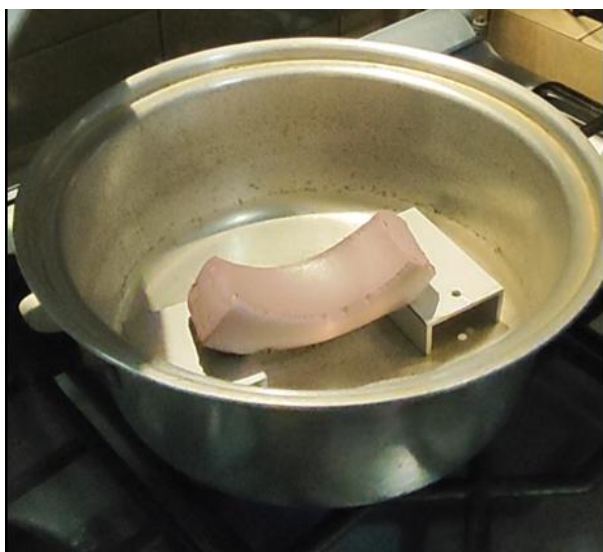
Ilustración 30. Aislante a 88 °C.
