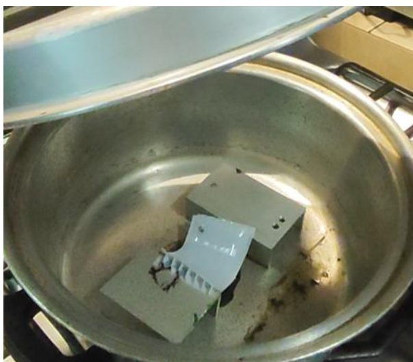
Ilustración 36. Policarbonato a 181 °C.
