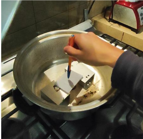
Ilustración 34. Policarbonato a 123 °C.
