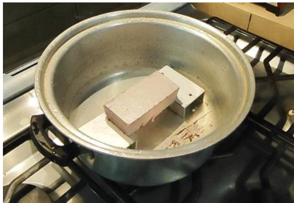
Ilustración 28. Colocación de aislante en olla para experimento.
