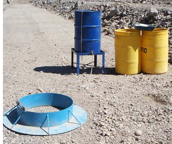
Figura 2. Cala volumétrica y equipo
