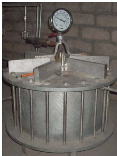
Figura 10. Equipo para estanqueidad
