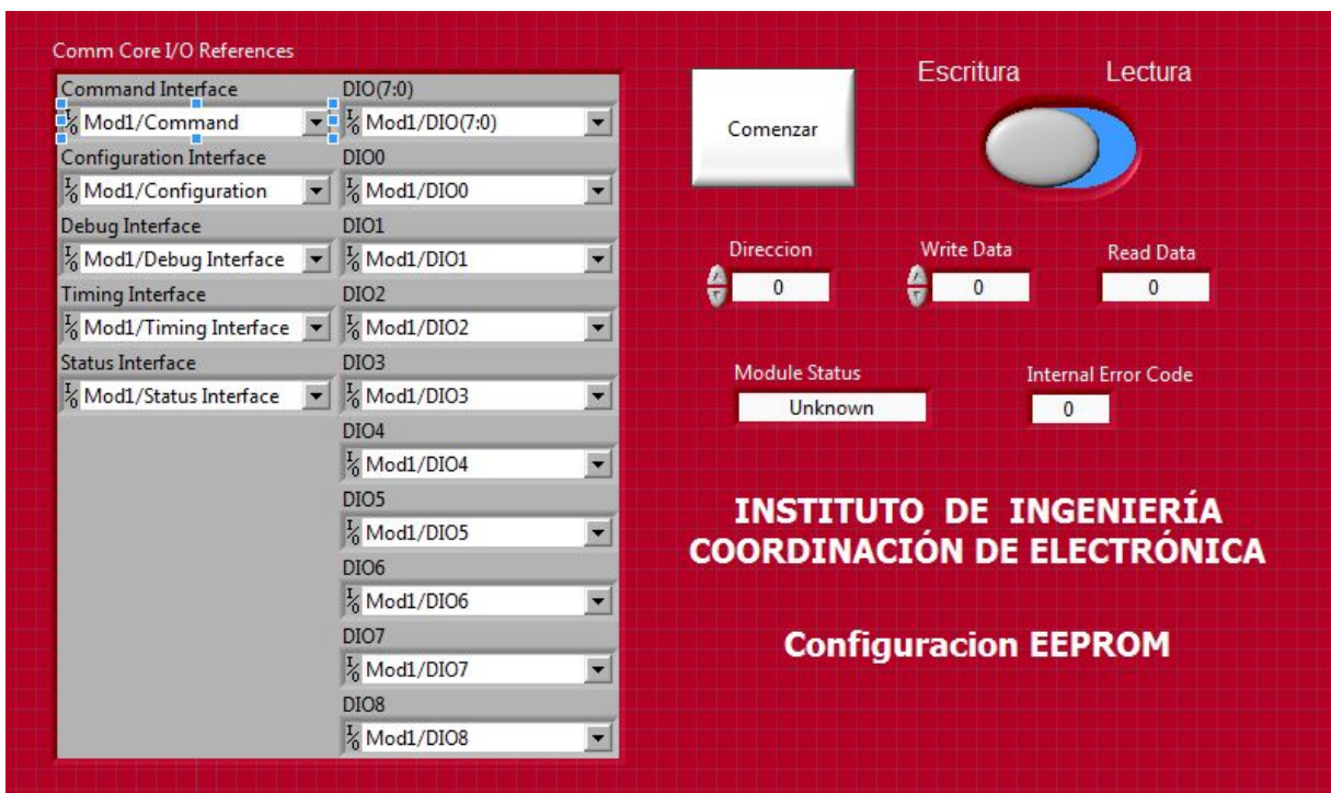
Figura 7. Programa en LabVIEW para la escritura y lectura de datos de una memoria EEPROM conectada a un Módulo C.
