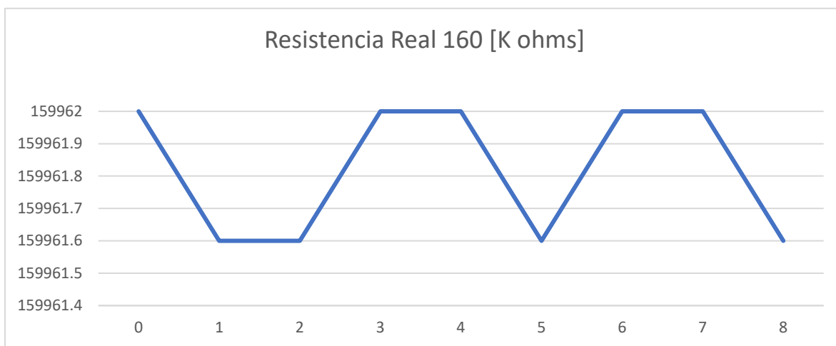
Figura 104. Resultados obtenidos del módulo C teniendo una resistencia de 160 [K ohms] empleando el potenciómetro de precisión
