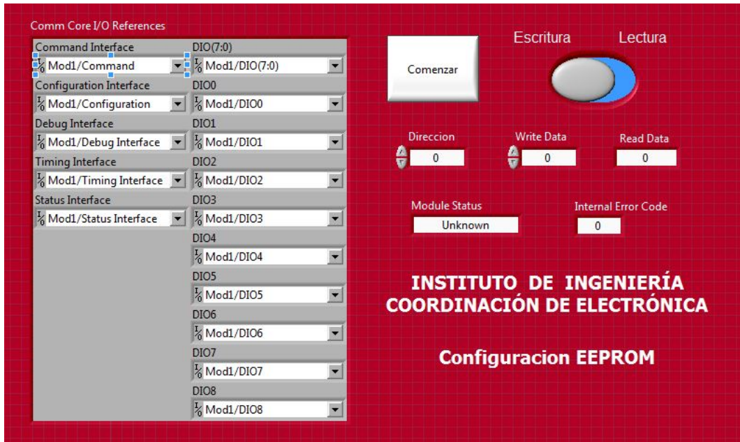
Figura 49. Interface gráfica del programa en LabVIEW para la escritura/lectura de la EEPROM
