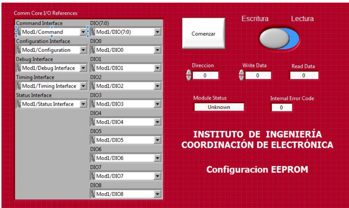
Figura 70. Programa en LabVIEW para la escritura y lectura de datos de una memoria EEPROM conectada a un Módulo C
