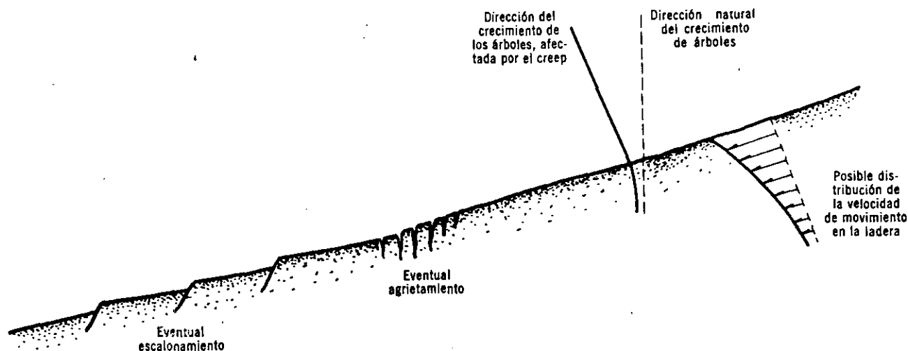
Figura VI-3. Signos del deslizamiento superficial.
