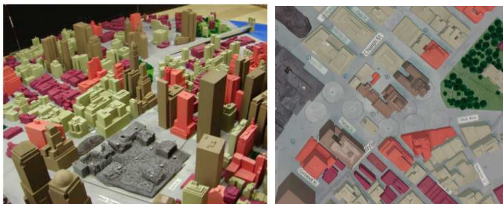
(a) Modelo a escala 1/600 de la periferia del WTC en New York (b) Las mediciones de velocidad se hicieron por anemometría láser Doppler (LDA)
