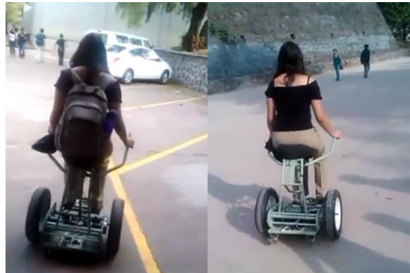
Figura 7-6.- Primera prueba del VEPI con pasajero conduciendo.
