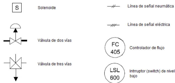
Figura 2.10 Simbología de diagramas de instrumentación
