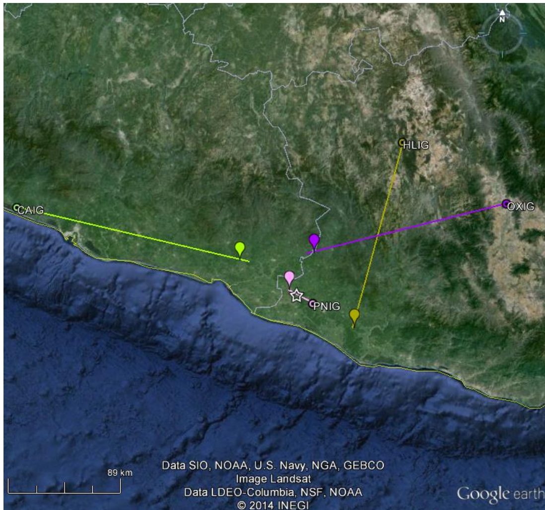
Figura 27. Localización del sismo local 2. En colores se muestran las localizaciones obtenidas de cada estación a través de obtener el acimut de la señal con cada una (PNIG, CAIG, HLIIG y OXIG). La estrella blanca, representa la localización obtenida con SEISAN.
