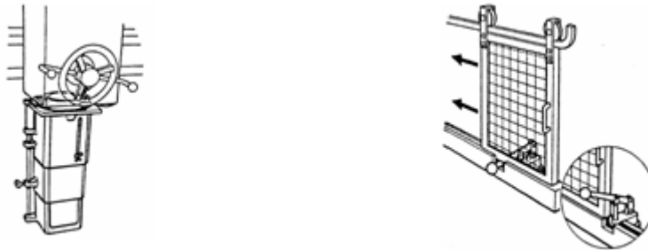
Figura 13. Resguardos con dispositivo de enclavamiento
