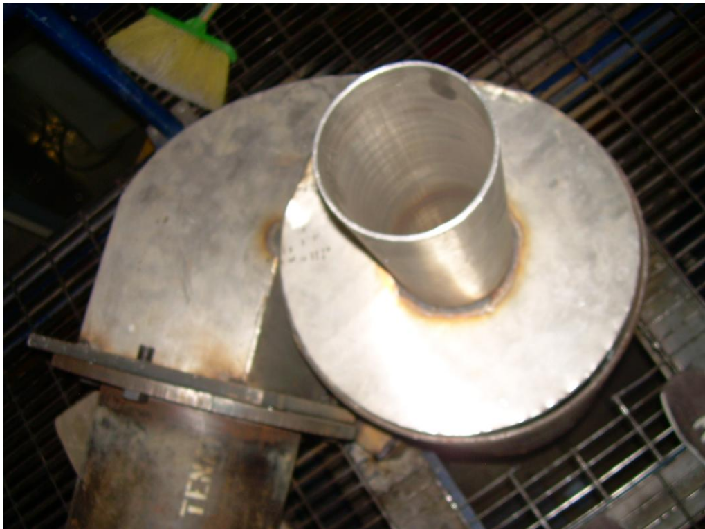
Figura 2-4: Vista superior del ciclón colector de partículas (elaboración propia).
