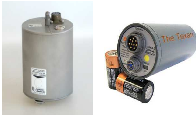
Figura 6.2.- Sensor de velocidad de 5 segundos modelo Lennartz LxD-5 con respuesta de los 0.2Hz en adelante. Digitalizador Reftek modelo 125A.
