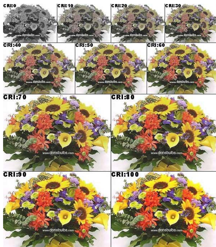
FIGURA II.19: Ejemplo de variación de escala de ICR en una imagen.
