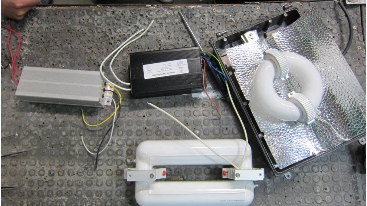
FIGURA VI.5: Presentaciones de los sistemas de inducción electromagnética inductor externo.
