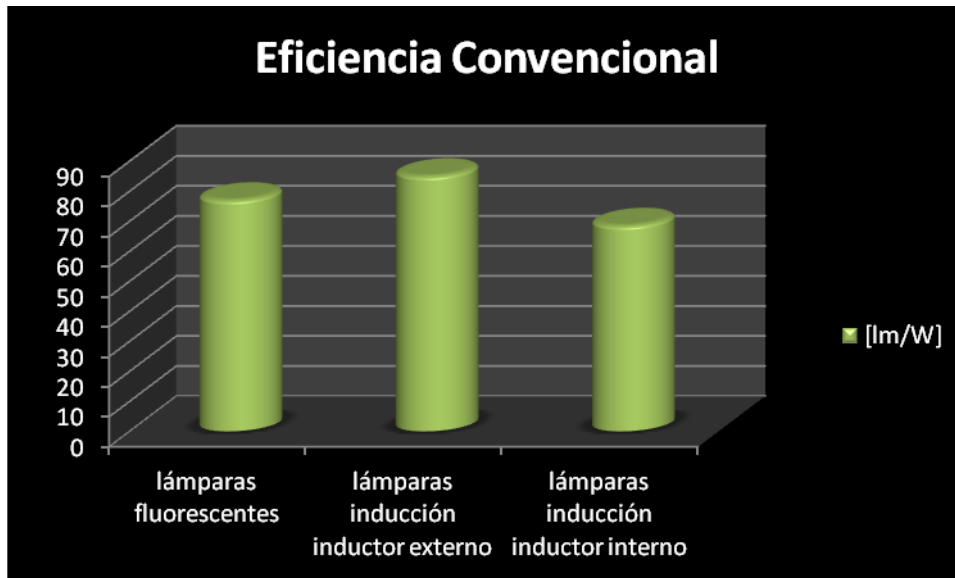
FIGURA V.8: Eficiencia convencional de lámparas fluorescentes RS y de inducción con valores promedio.
