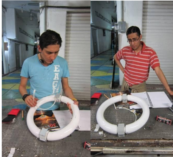
FIGURA VI.6: Ejemplo de lámpara de inducción electromagnética inductor externo de 250 W.
