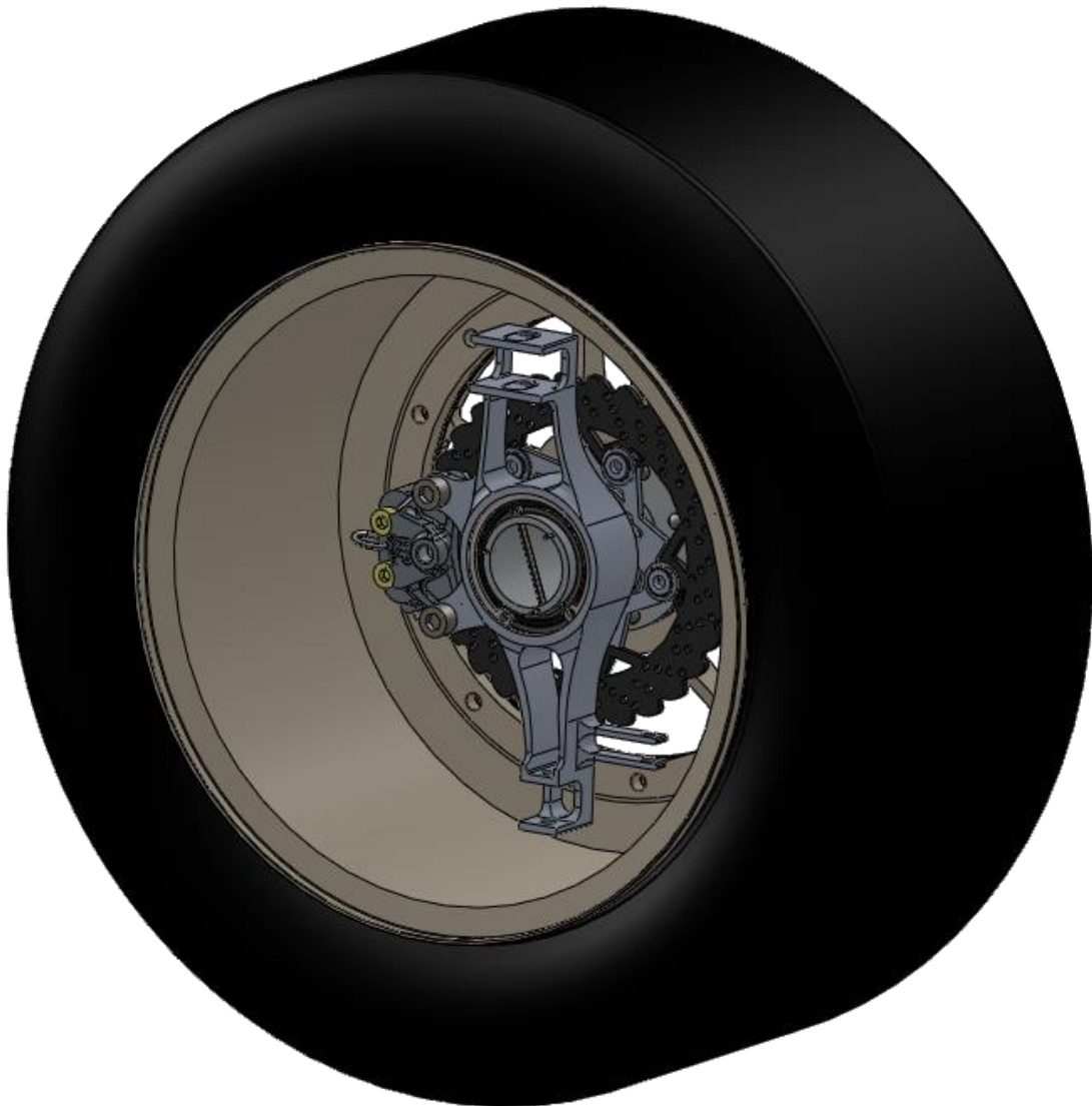
Ensamble final de rueda delantera para prototipo UM-515.
