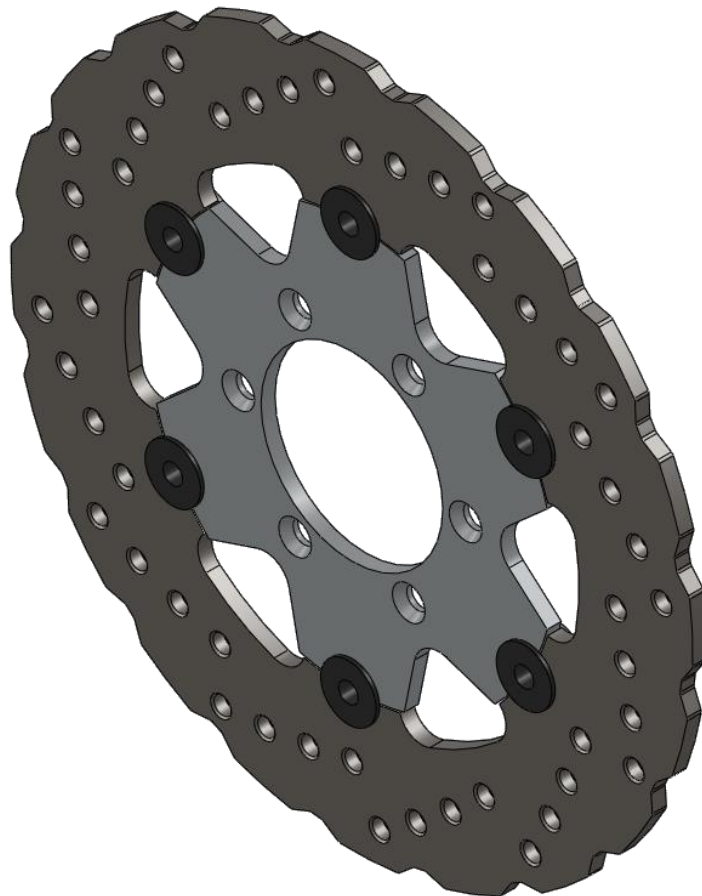
Disco de freno para prototipo UM-524 (temporada 2013).
