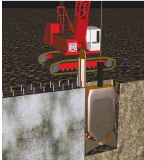
Figura V. IX Detalle de excavación de una Almeja como herramienta de excavación
