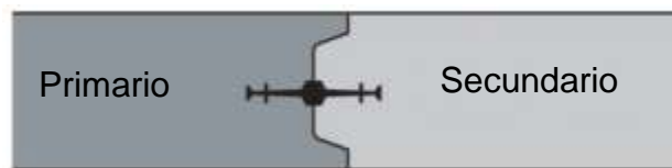
Figura V. XI Junta CWS, junta entre un panel secundario y primario en este caso con una junta Water-Stop de por medio
