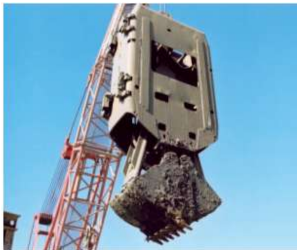
Figura V. VIII Almeja mecánica autoguiada por cables, funciona de la misma manera que una almeja hidráulica pero su potencia es limitada
