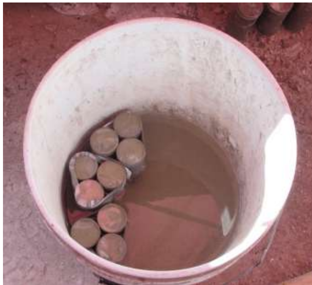
Figura IV. X Muestras de lechada en paquetes de 3, para ser ensayadas al día 1, 3 y 7
