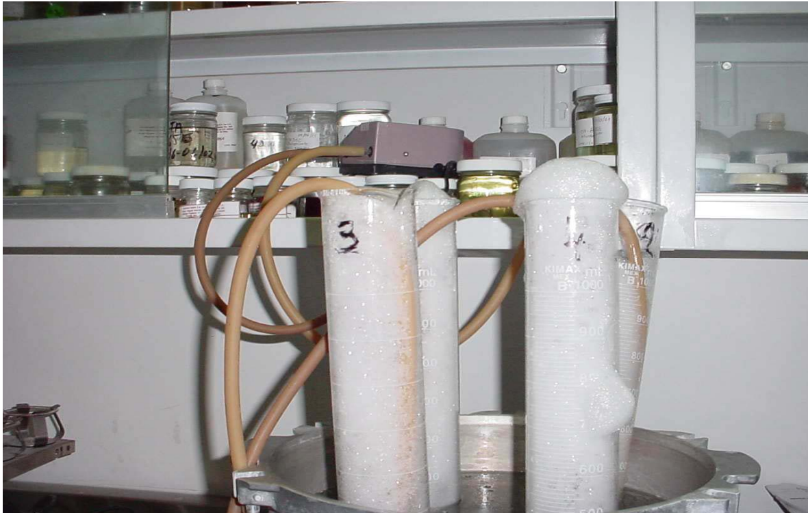
Imagen 5-2. En la imagen se muestra el derrame del fluido en los cilindros 11 .
