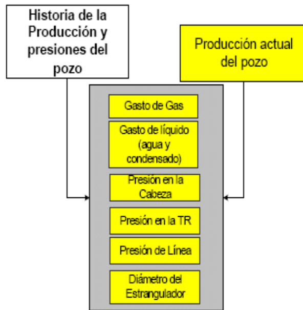
Figura 5-3. Información mínima requerida para el análisis de la historia de producción de un pozo 10 .
