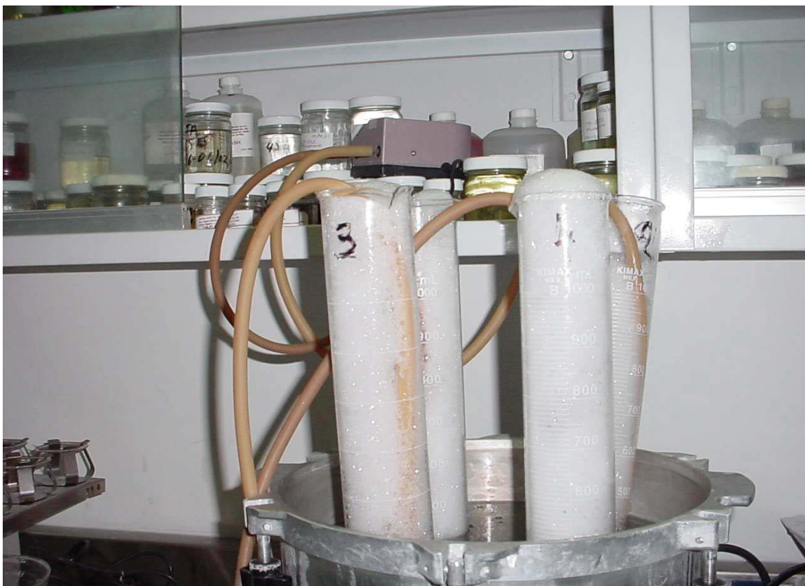
Imagen 5-1 La muestra de líquido que contiene agente espumante es agitada manual mente en cilindros de vidrio 11 .
