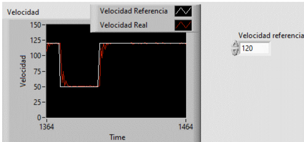
Figura 74. Gráfica de velocidad del motor con control PID
