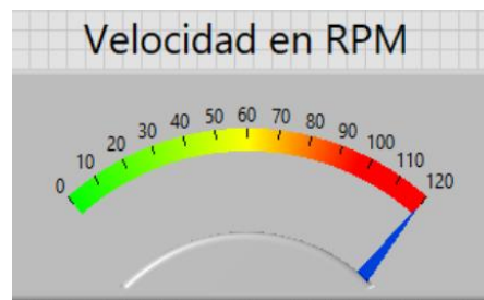
Figura 46 Interfaz en Labview para controlar la velocidad de un motor
