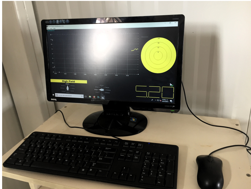
FIGURE 2.18: Computadora que recibe los datos del Boltek-EFM100
