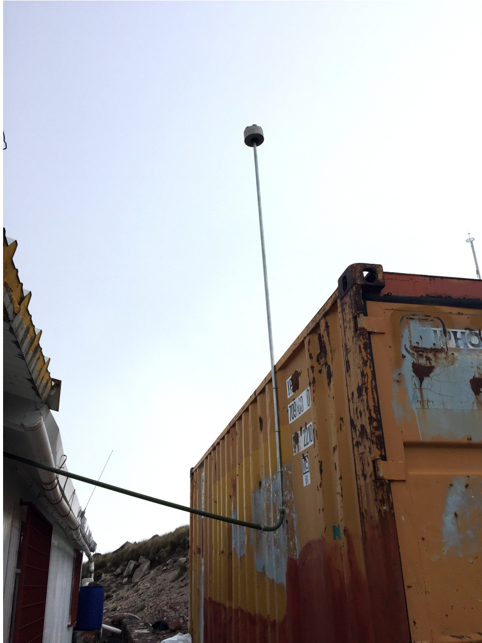
FIGURE 2.16: Boltek EFM-100 instalado en Sierra Negra
