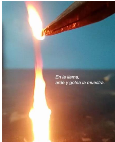
Figura 52: Prueba 3, en la llama.
