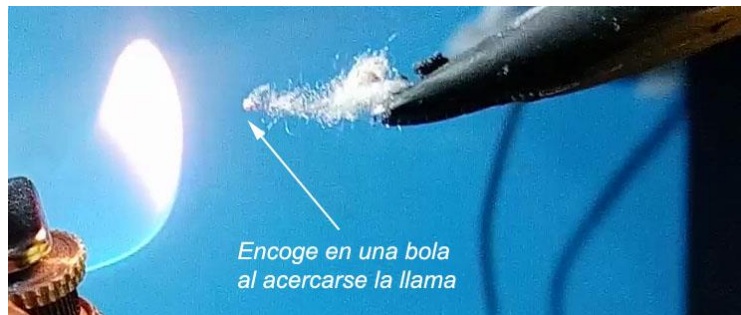
Figura 50: Prueba 1, acercamiento de llama.
