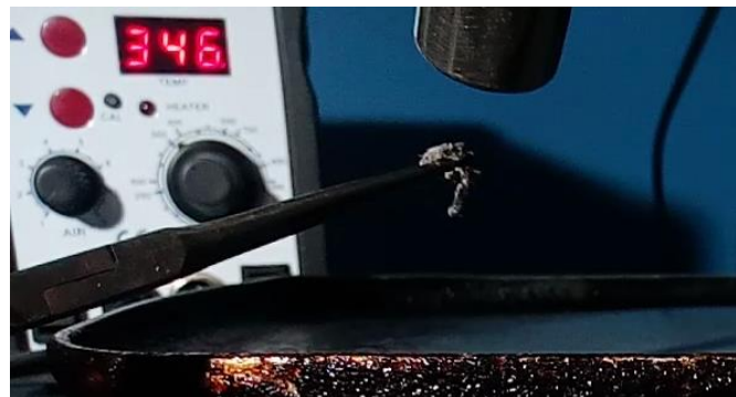
Figura 51: Prueba 2, Haciendo uso de una estación de soldar a 346°C la muestra no se fundía, descartando la clasificación de termoplástico.
