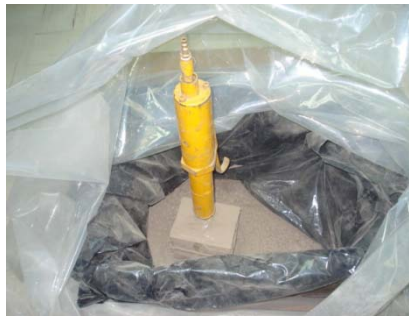
Figura 4. 1. Pistón utilizado para tamizar el suelo tipo arcilloso.
