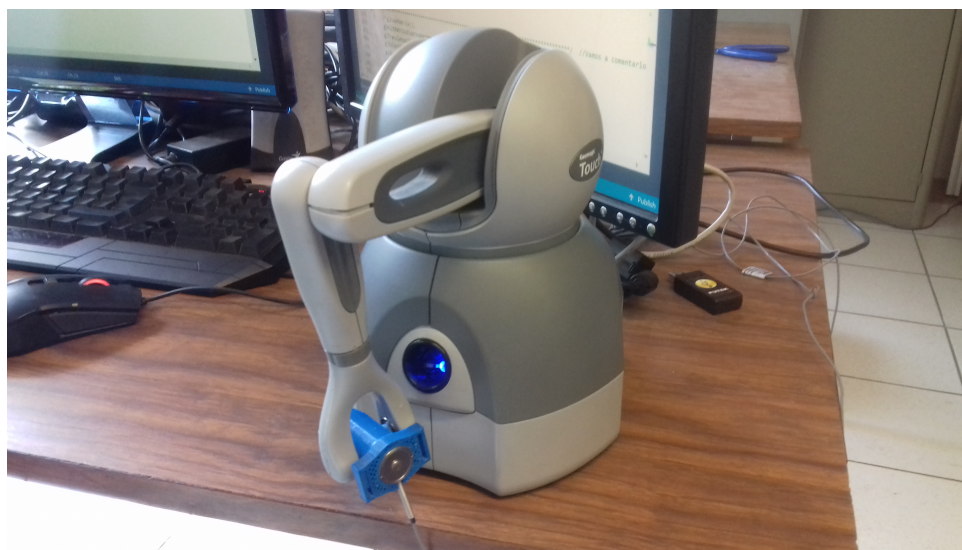
Figura 3.7: Robot con el sensor de fuerza adaptado.
