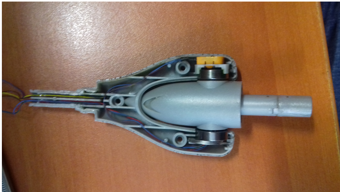
Figura 3.4: Muñeca esférica del robot Geomagic Touch.
