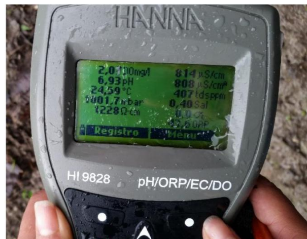
4.13. Vista en pantalla de algunos parámetros medidos con el dispositivo Hanna.
