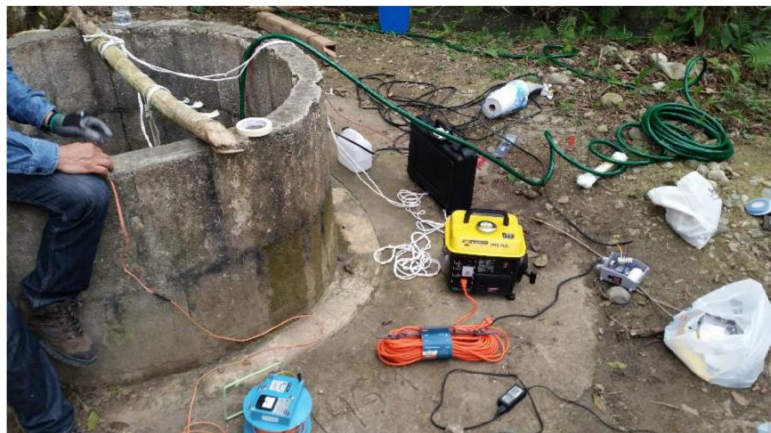
Fig. 4.9. Montaje del equipo en la noria 4, para realizar la prueba de bombeo.
