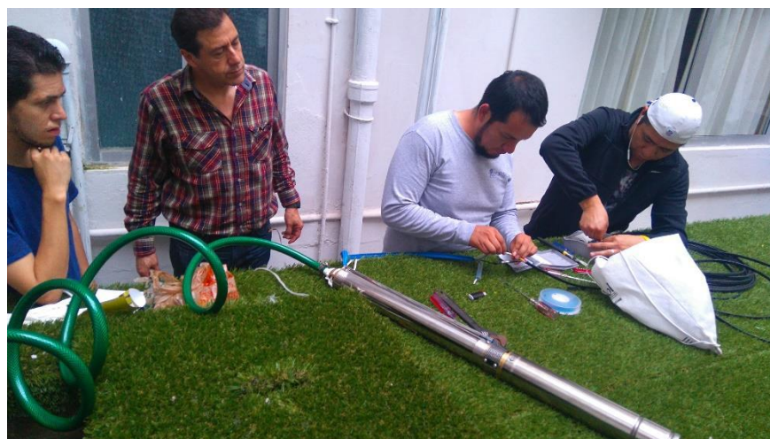
Figura 4.7. Bomba sumergible. Equipo conectando los aditamentos necesarios para hacer las pruebas.
