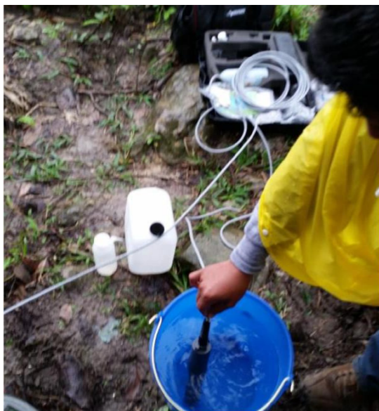
4.12. Toma de parámetros con el laboratorio portátil Hanna
