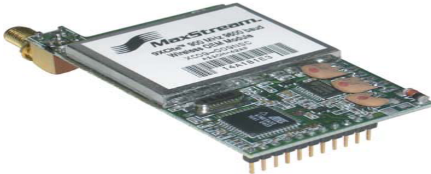
Figura 2.7.- Fotografía del radiomódem MaxStream 9 Xcite, usado en nuestro sistema de simulación.
