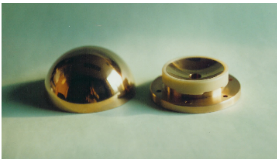
Figura. 1.4.- Semiesfera y copa, partes fundamentales de un balero de aire esférico.
