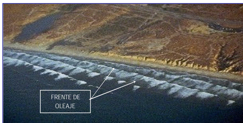
Figura 4.9 La refracción en el oleaje puede producir una disminución en la longitud y aumento en la altura de ola.
