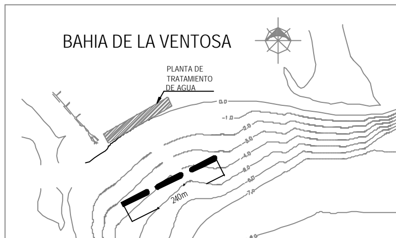
Figura 5.15 Arreglo en planta de la protección marginal, en la Bahía de la Ventosa, Salina Cruz, Oax.
