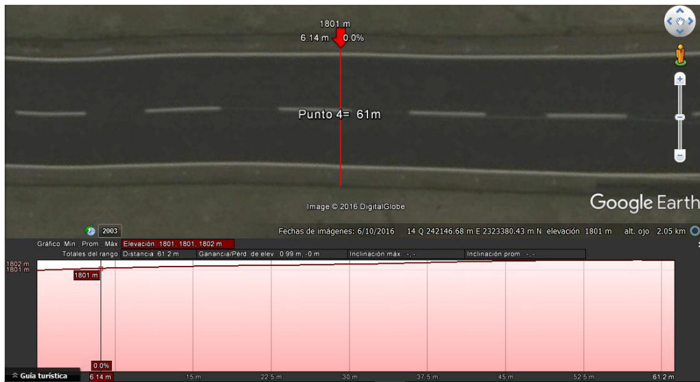
Imagen 15. Pendientes de los márgenes de pista
