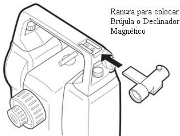
Figura 8. Se orienta la estación con ayuda de este declinador magnético. Manual del usuario Sokkia 2006 Japón.
