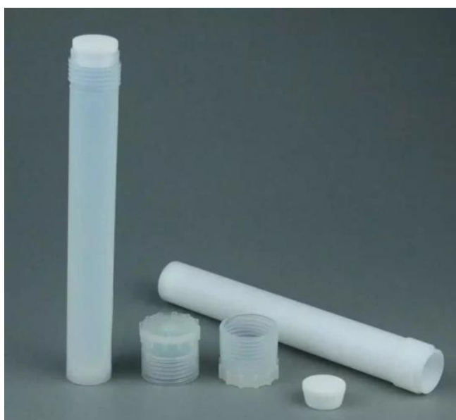
Imagen 25: Tubos liners del horno MARS 6.
