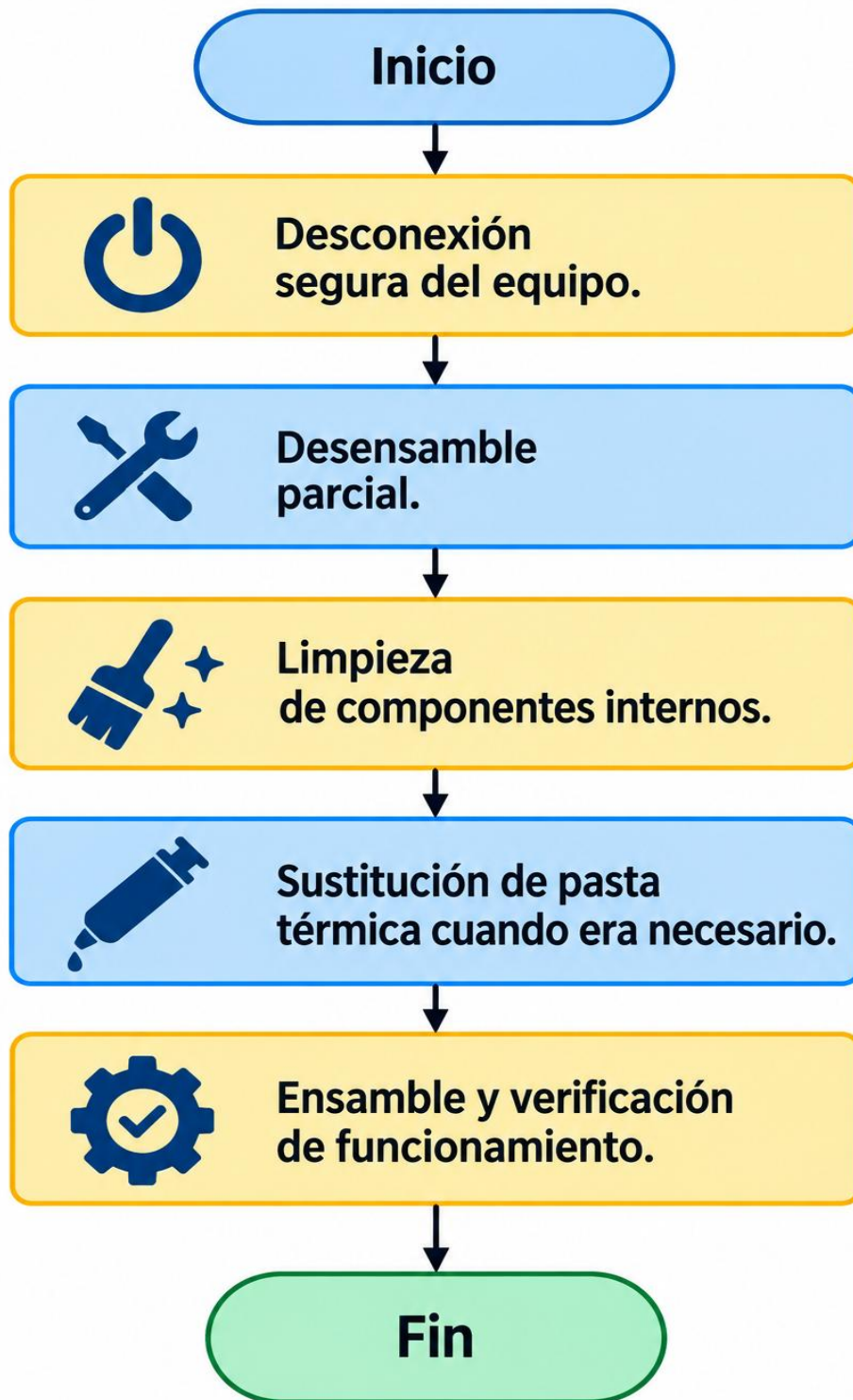
Figura 3.4 Procedimiento para la sustitución de pasta térmica del procesador.
