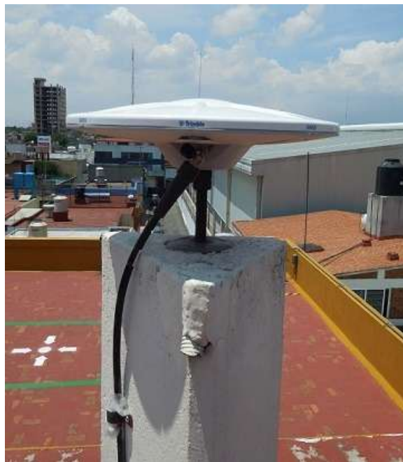
Figura 4.2: Antena del receptor Trimble Alloy GNSS TOL2 perteneciente a la Red Geodésica Nacional Activa del INEGI.
