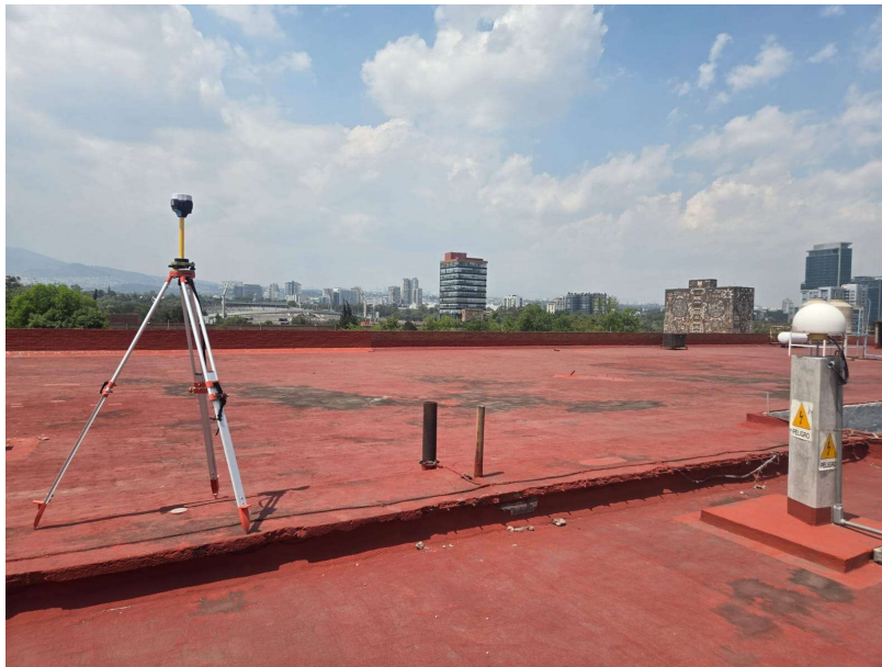
Figura 4.6: Línea base corta entre FICU y Emlid Reach .
