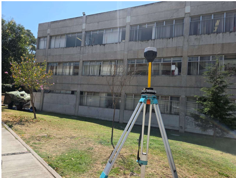
Figura 4.4: Antena del receptor Emlid Reach usado en este trabajo de tesis.
