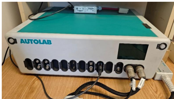
Figura 7. AUTOLAB modelo PGSTAT302N. Autoría propia
