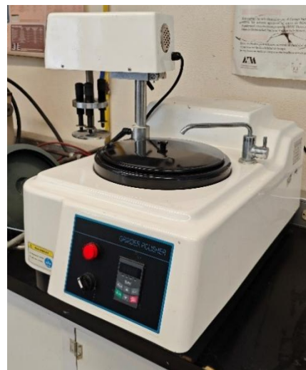
Figura 4. Pulidora metalográfica modelo Mp-1B, autoría propia
