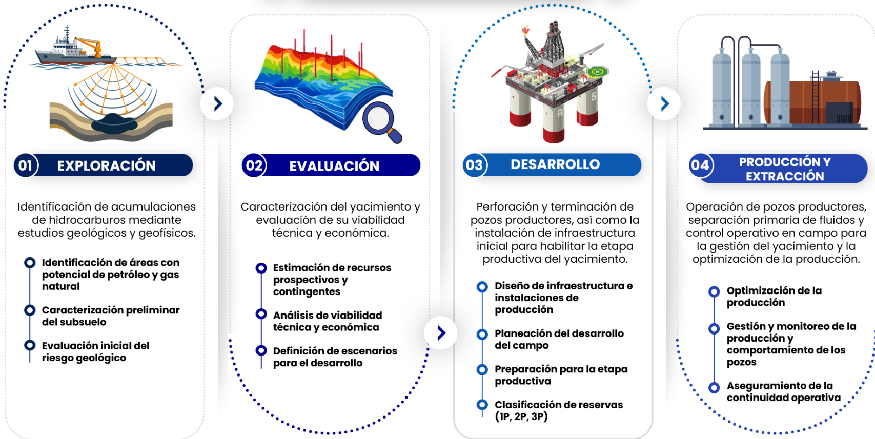
Figura 54. Fases del upstream en la cadena de valor del gas natural.
