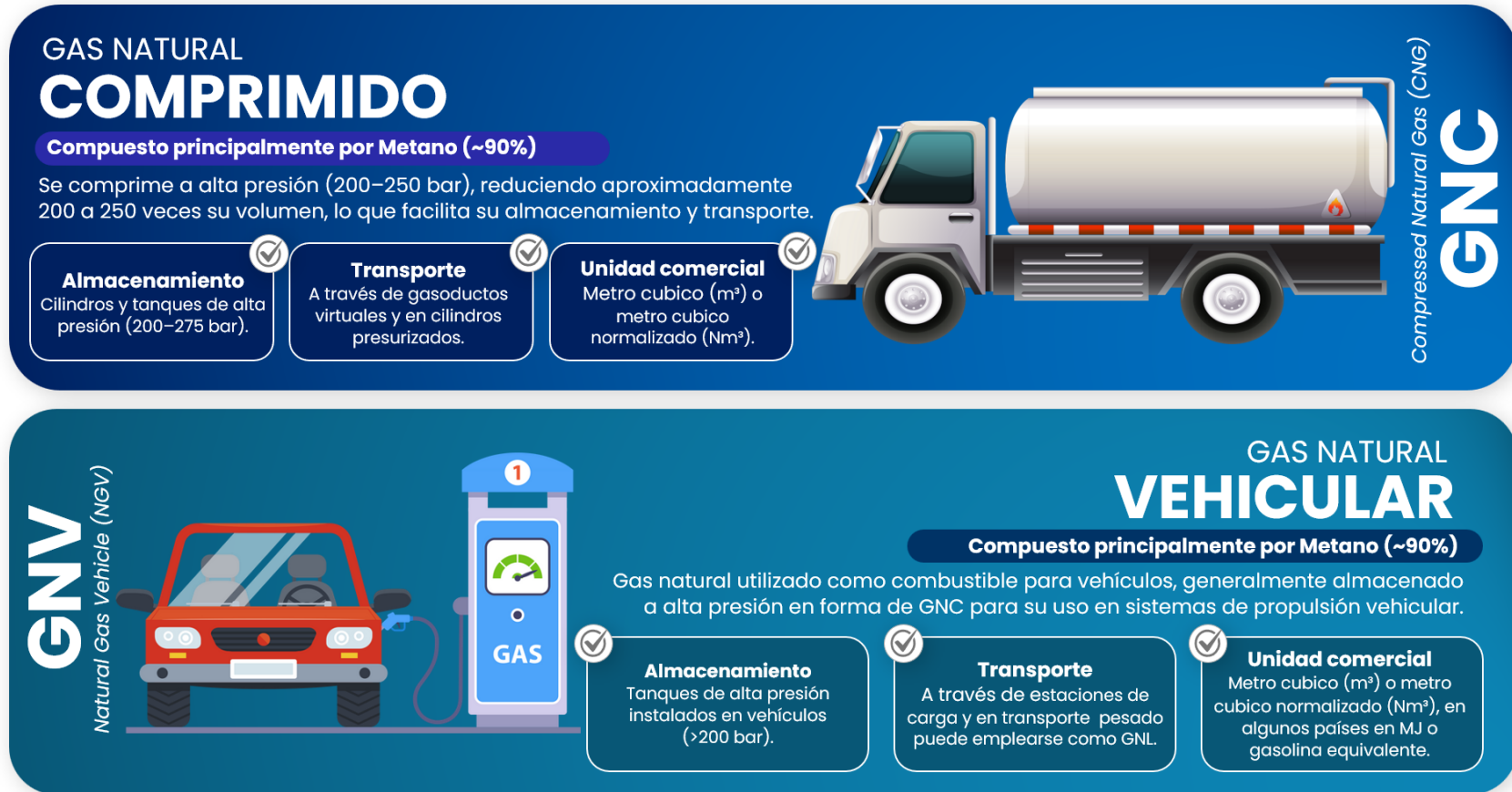
Figura 14. Modalidades comerciales del Gas Natural Comprimido (GNC) y del Gas Natural Vehicular (GNV).
