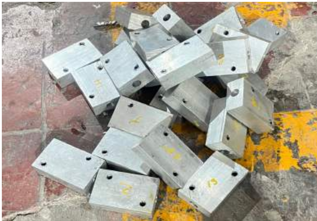
Fig. 6. Bloques de aluminio mecanizados para el alojamiento geométrico y soporte de las resistencias eléctricas.
