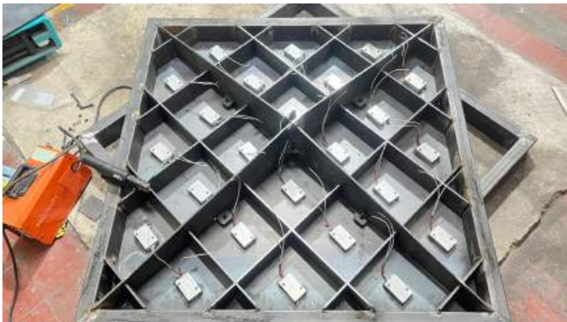
Fig. 9. Montaje de los elementos calefactores sobre la plancha de presión de la prensa
