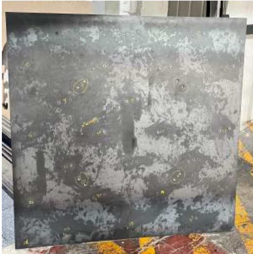
Fig. 7. Vista de la plancha de acero al carbono avellanada para garantizar la uniformidad geométrica y el contacto térmico del sistema.
