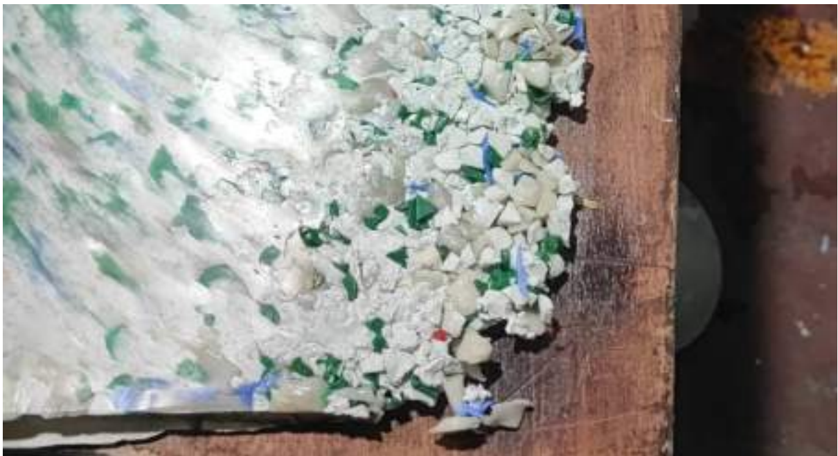
Fig. 38. Evidencia de defecto de consolidación y plastificación incompleta en los bordes de la placa de plastimadera debido al gradiente térmico periférico.
