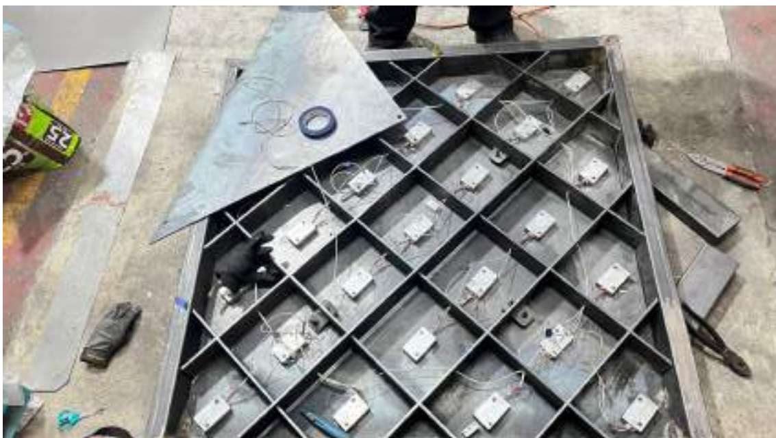
Fig. 10. Conexión de potencia tipo BUS integrada en el conjunto de las planchas de presión.
