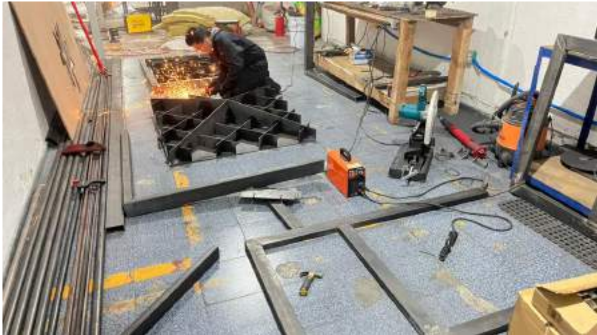
Fig. 5. Proceso de habilitación, ensamble y consolidación estructural del bastidor de la prensa térmica.
